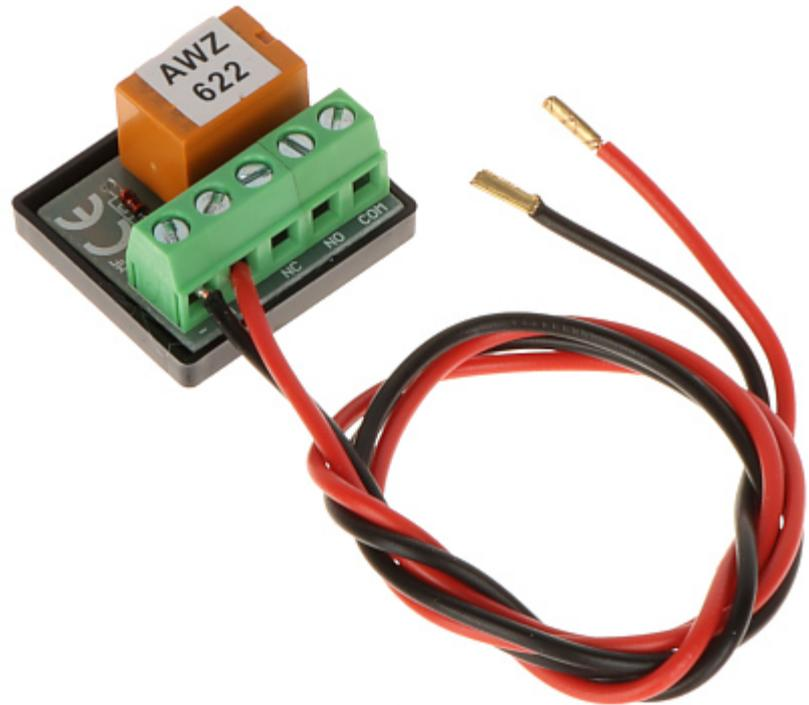
Permite aumentar la carga máxima de las salidas de transistor y proporciona aislamiento galvánico entre la señal de disparo y el punto de carga.
