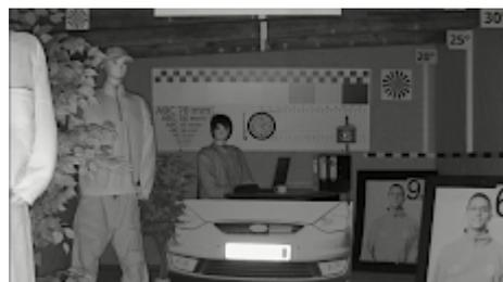
Kamerabild bei starker Beleuchtung, die sich direkt gegenüber der Kamera befindet:
