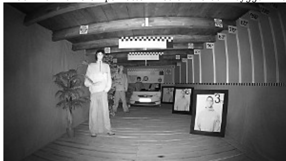
Bilden från kameran på natten med aktiverad inbyggd IR-belysning:
