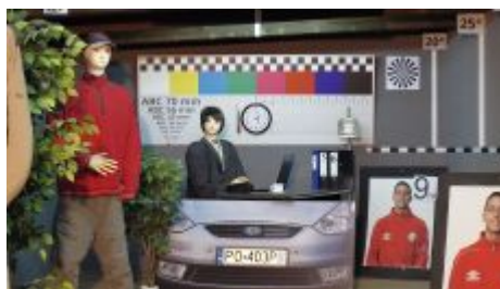
Slika iz kamere pri delu ponoči z vklopljenim vgrajenm osvetljevalnikom IR:
