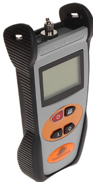
La source de lumière laser SP-OSM32 vous permet de générer un faisceau de lumière d'essai dont la longueur de l'onde est de 1310 nm / 1550 nm. Grâce à cela, en utilisant n'importe quel appareil de mesure de puissance optique, il est possible d'évaluer rapidement et précisément l'état des fibres optiques et de ses connexions dans l'installation testée.
