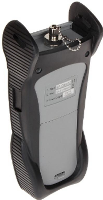
Vue du derrière (endroit pour la batterie):
