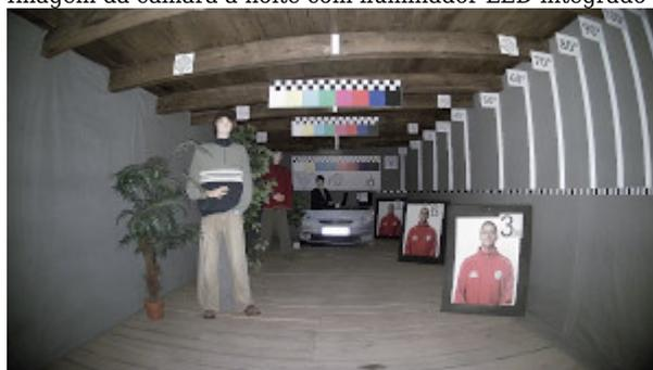
Imagem da câmara à noite com iluminador IR integrado activado:
