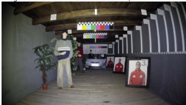
Image de la caméra fonctionnant de nuit, avec l'illuminateur IR intégré allumé:
