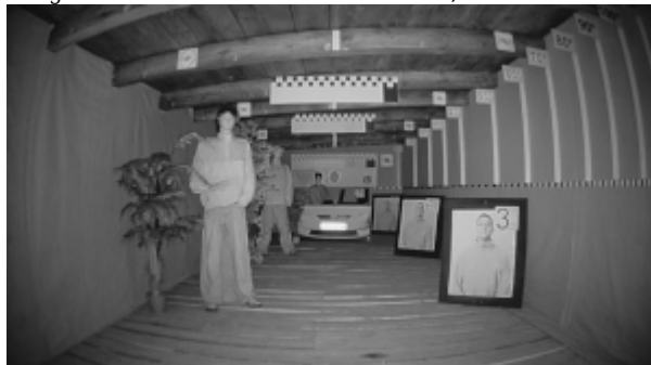
Image de la caméra fonctionnant de nuit, avec l'illuminateur IR intégré allumé:
