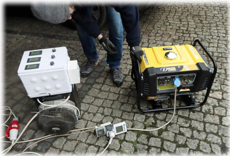
Die vom Hersteller angegebene Nennleistung des Aggregats hat mit unseren Tests übereingestimmt.:
