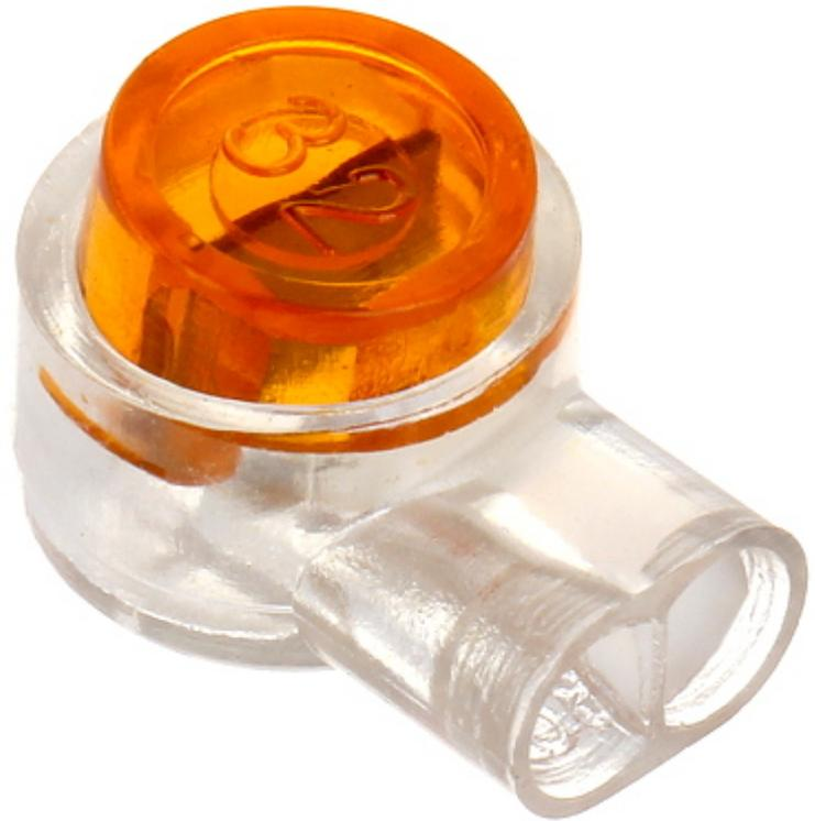
Der Steckverbinder verbindet auf schnelle und hermetische Weise 2 Telekommunikationskabel ohne die Notwendigkeit der Abnahme der Isolation.
