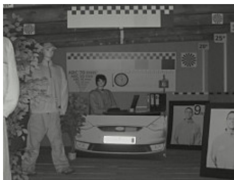
Slika iz kamere pri močni svetlobi nastavljeni iz smeri nasprotne usmerjenosti kamere:
