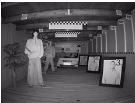
Slika iz kamere pri močni svetlobi nastavljeni iz smeri nasprotne usmerjenosti kamere:
