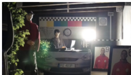
Kameran kuva suoralla vahvalla valolla kameraa vastapäätä:
