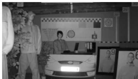
Kameran kuva suoralla vahvalla valolla kameraa vastapäätä:
