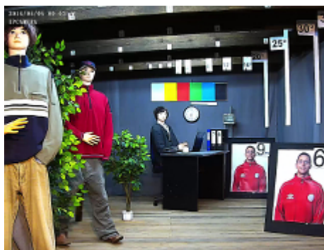
Kamera kép éjszakai üzemmódban bekapcsolt beépített IR megvilágítóval:
